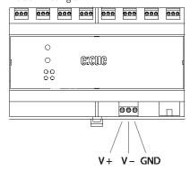
Schalten Sie die Spannungsversorgung erst an, wenn alle Kabel angeschlossen sind. Liegt Spannung an, startet der SYMPL essential2 Node sofort. Das Gerät ist betriebsbereit, wenn die LED Status blinkt.
